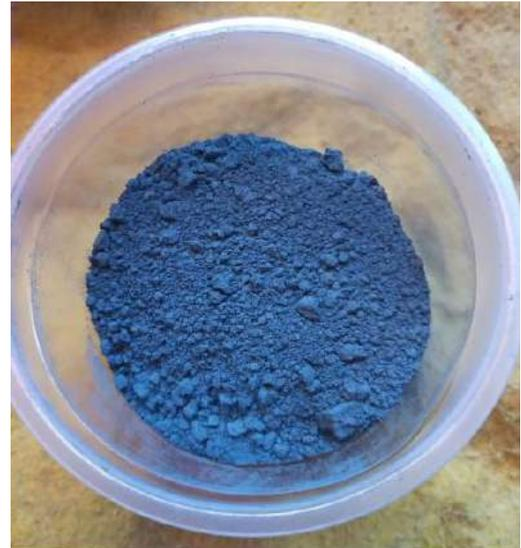
Espinela  $\text{CoAl}_2\text{O}_4$  obtenida a partir de cobalto recuperado de baterías
